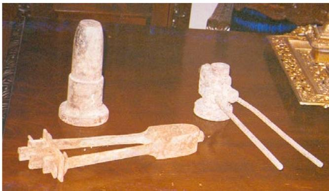
**Fig. 9 – Attrezzi in ferro per la lavorazione del vetro**
